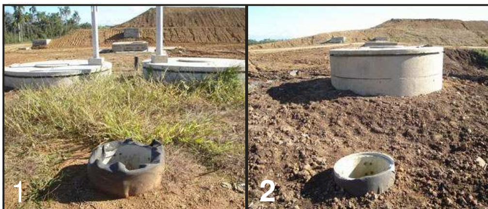
FIGURA 7 – Ponto de coleta da água subterrânea (dreno em primeiro plano) e do chorume (tanques em segundo e terceiro plano) (MANGILI, 2006).
